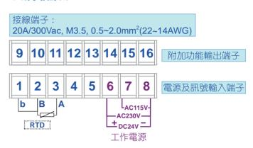
接線時,請務必確認電源電壓是否正確並接入正確端子編號。為設備及儀錶安全,建議在儀錶前安裝保險絲(Fuse)或斷路器(Breaker)。
