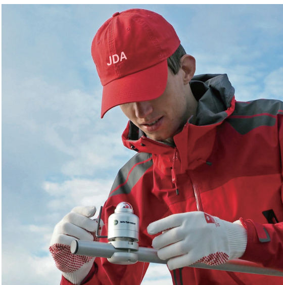
圖2 SR05 使用管型扣件與球型水平座可輕鬆調整校正水平交度。SR05 使用工業標準數位以及類比輸出。
